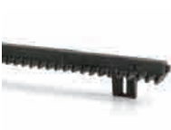
ROA6 Cremagliera M4 25x20x1000 mm asolata in nylon con inserto metallico. Per cancelli di peso max 500 kg. Pz./Conf. 10
